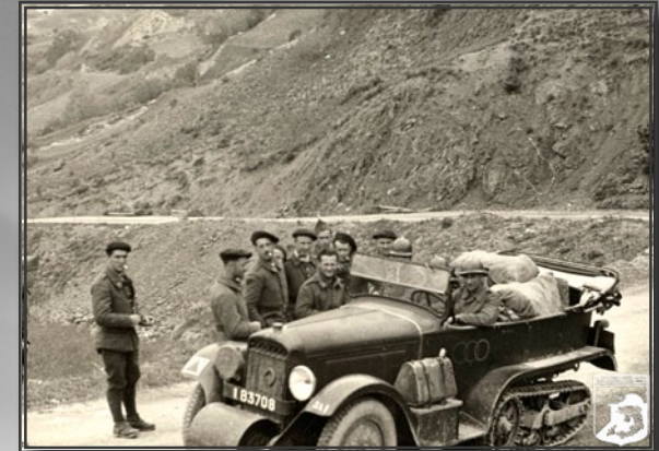
Le véhicule semi-chenillé permet de ravitailler la position sous Saint-Ours. Il s'agit d'un véhicule de liaison tout terrain de marque Citroën-Kégresse, type P19 B.
